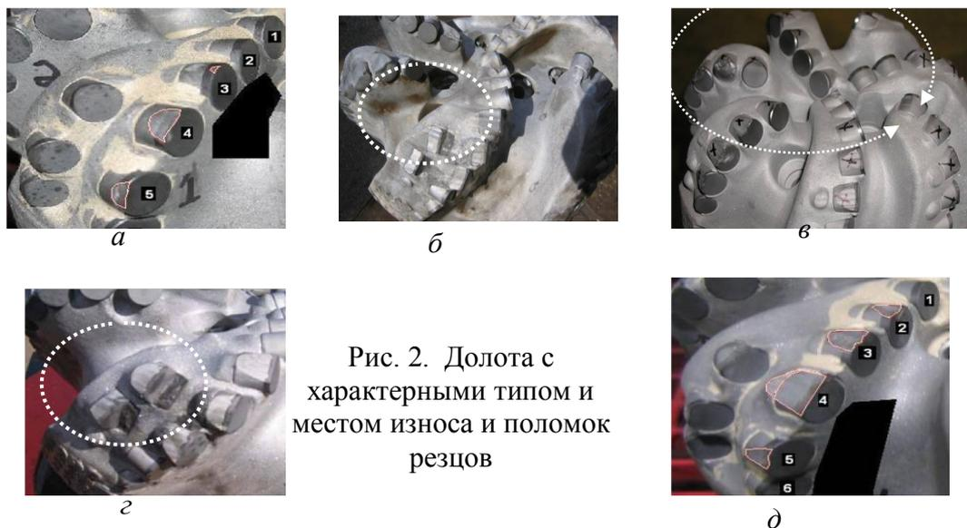
Рис. 2. Долота с характерными типом и местом износа и поломок резцов
