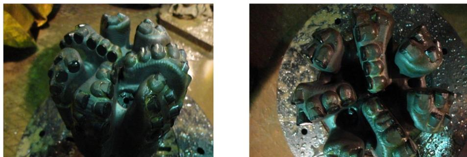
Рис. 3. Долота, изношенные в процессе бурения в Восточной Сибири (Юрубчено-Тахомкое нефтегазовое месторождение)
