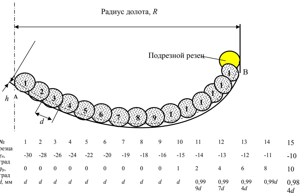
Рис. 8. Схема раскладки резцов *PDC* по линии резания-скалывания:  $h$  – заданная глубина резания-скалывания горной породы;  $d$  – поперечный размер резца в раскладке с учетом фронтального угла резания-скалывания  $\varphi_{\text{р}}$
